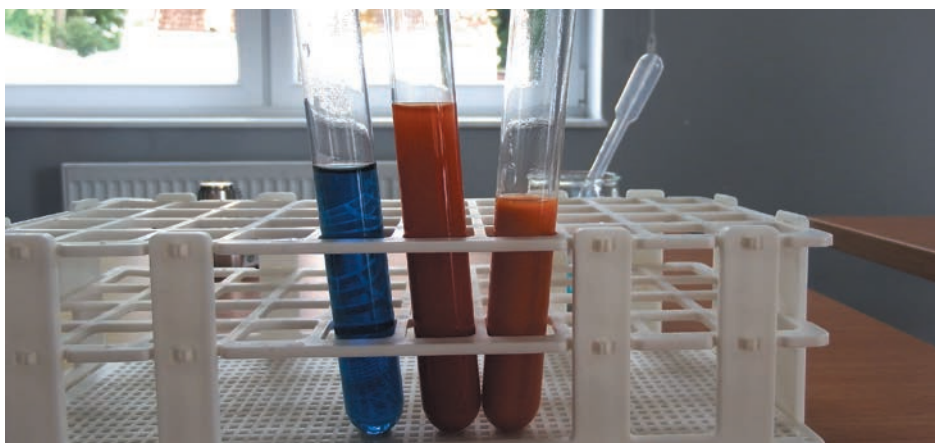
Próba Trommera wykonana w celu wykrycia glukozy w różnych produktach spożywczych. Kolor niebieski - próba negatywna, kolor pomarańczowy - próba pozytywna.
