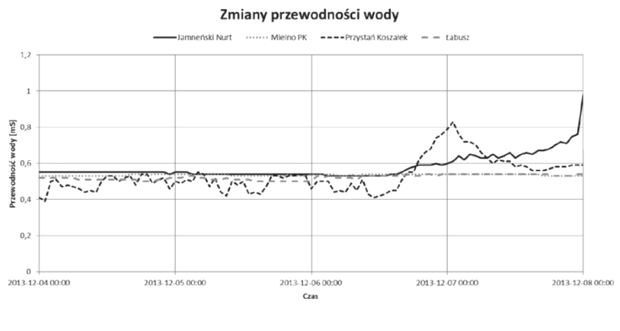
Ryc.9. Wykres zmian przewodności elektrolitycznej wód jeziora Jamno w okresie występowania „Orkanu Ksawery” od 4 do 8 grudnia 2013 roku.
